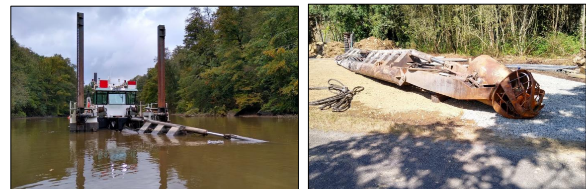
FIGURE 14 - DRAGUE ASPIRATRICE STATIONNAIRE ET SON CUTTER (SOURCE : INGEROP)
